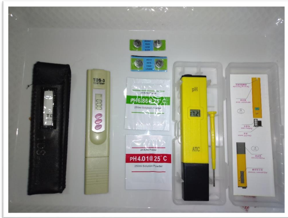
رسم توضيحي46: أجهزة قياس ال pH وال EC(مؤسسة الجذور العالمية IRCAT)
