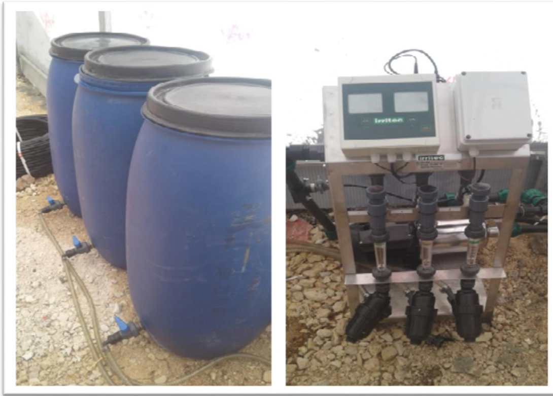
رسم توضيحي45: اضافة المحلول المغذي اتوماتيكياً (جمعية أيادي البادية – المفرق)
